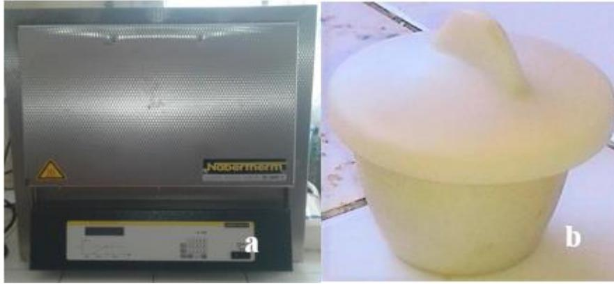
**Figure 6** : Dispositif de calcination, (a) four à moufle et (b) creuset en silice avec son couvercle
