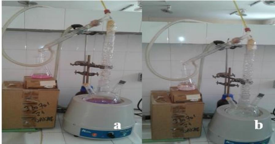
**Figure 9:** Dispositif de distillation, (a) début de la distillation et (b) fin de la distillation avec changement de coloration
