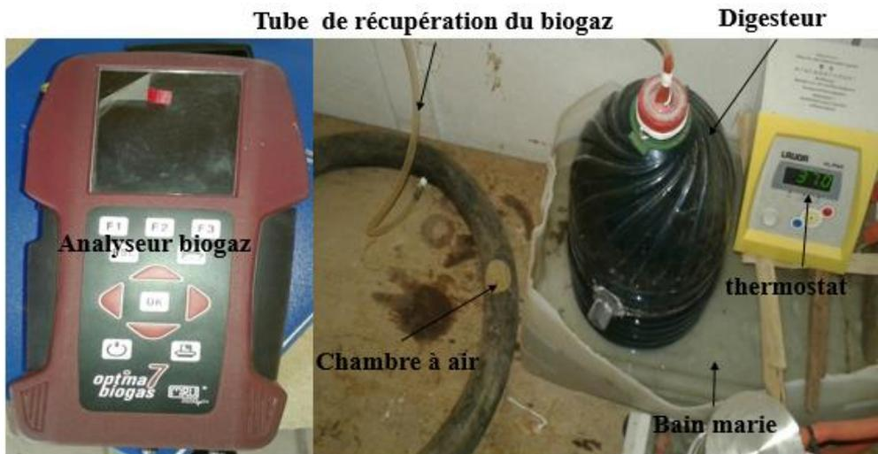
**Figure 12:** Dispositif de production et Analyseur de biogaz
