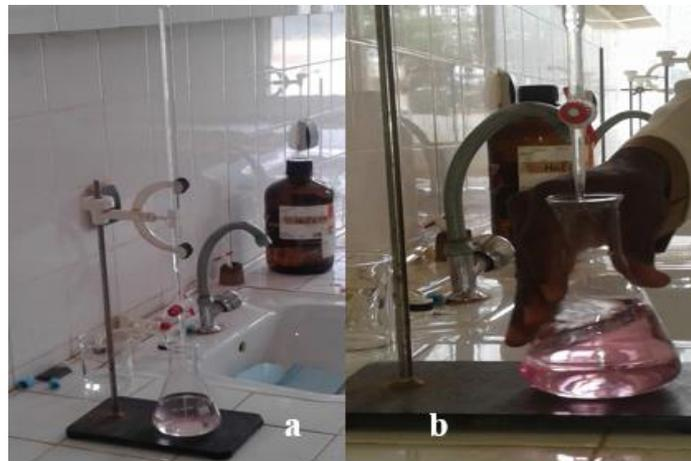
**Figure 10 :** Dispositif de dosage, (a) début du dosage et (b) virage de la coloration
