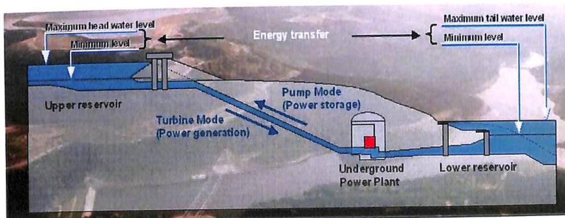
Figure 4 : Schéma de centrale de turbinage pompage
