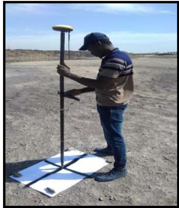
Photo 8 :Lever des points topographiques avec balises
