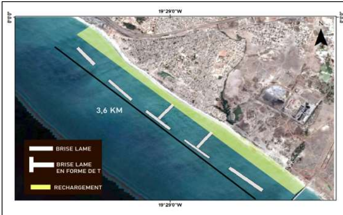
Figure 35: Séries de Brises Lames et d'Epis le long du littoral Bargnois.
