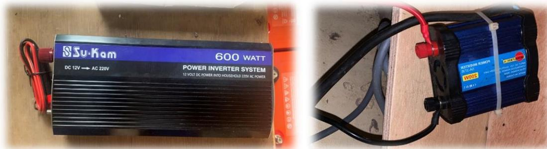
Figure 18 : Onduleurs 200 W et 600 W
