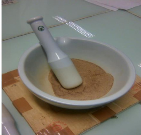
Photo 3 : Outil de désagrégation d'échantillon de sol (Diallo 2019)
