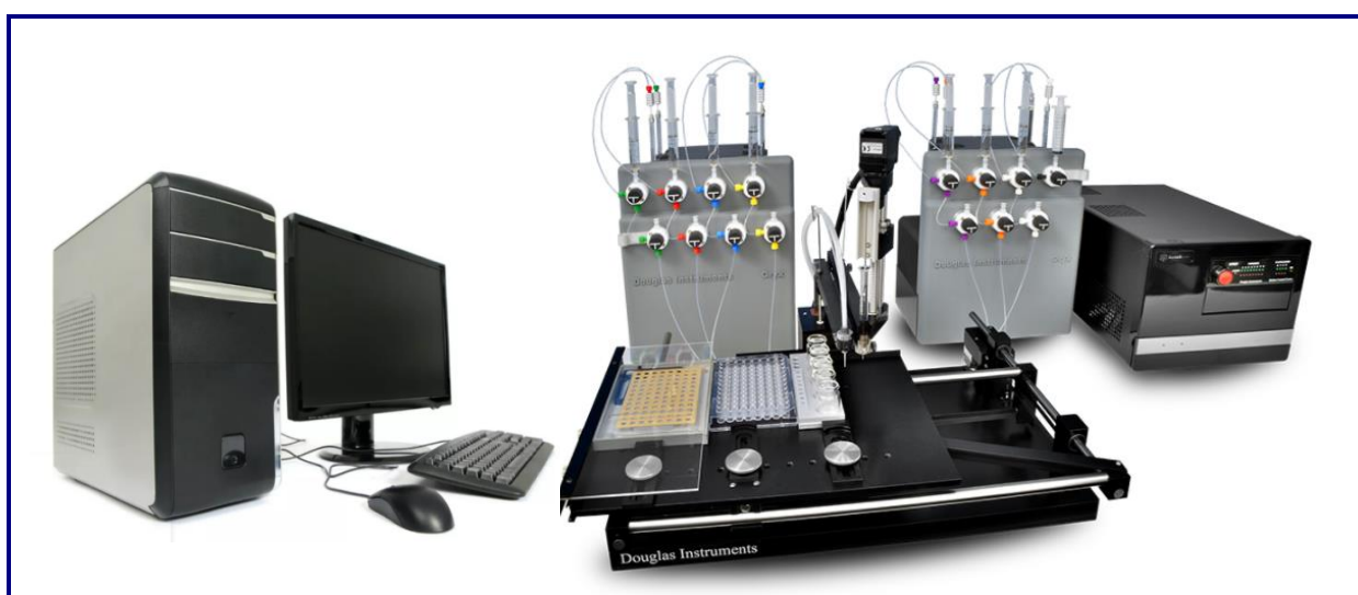
Figure 3 Exemple de matériel utilisé pour le criblage des conditions de cristallisation. Robot de cristallisation de type Oryx 8, disponible au laboratoire CRM2
