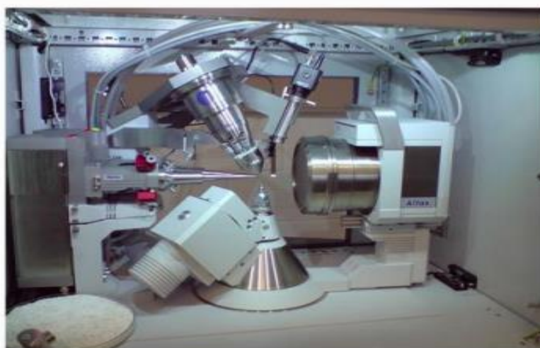
Figure 9 Diffractomètre supernova équipé d'un détecteur CCD Atlas
