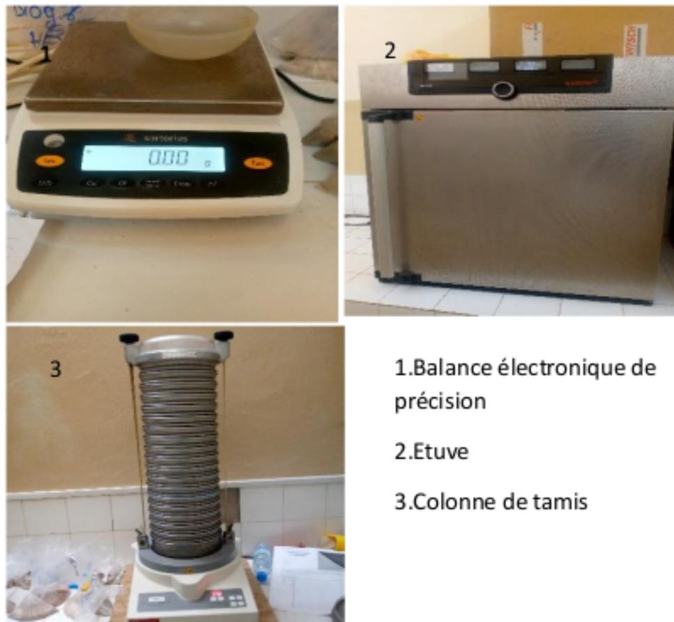
FIGURE 2.7 – Outils de traitements des échantillons de sédiments
