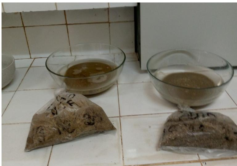
FIGURE 2.5 – Lavage des échantillons de sédiments bruts
