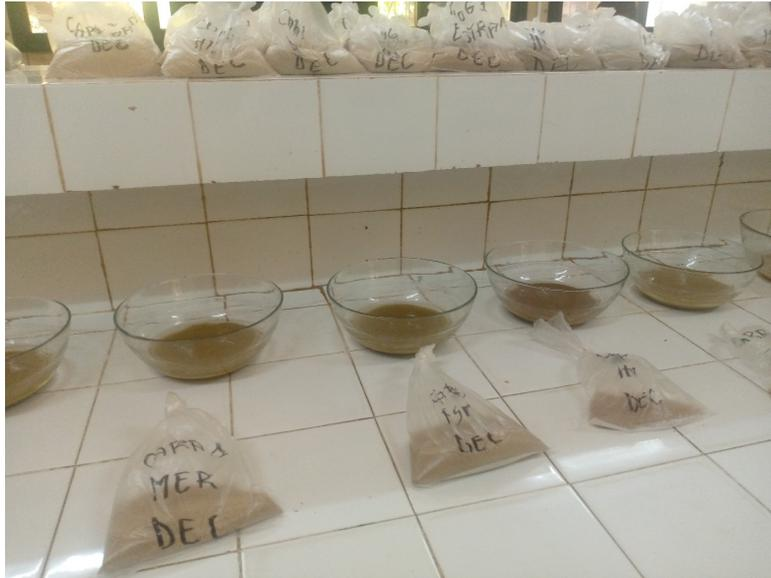
FIGURE 2.6 – Décarbonatation des sédiments (réaction entre l'acide et le carbonate de calcium)
