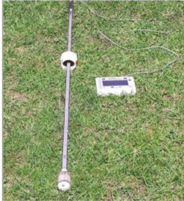
**Planche 5:** Mesure de l'humidité du sol à l'aide d'un Diviner 2000
