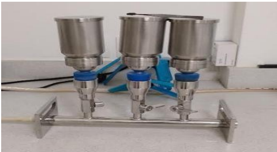
Figure 29: Rampe de filtration trois postes
