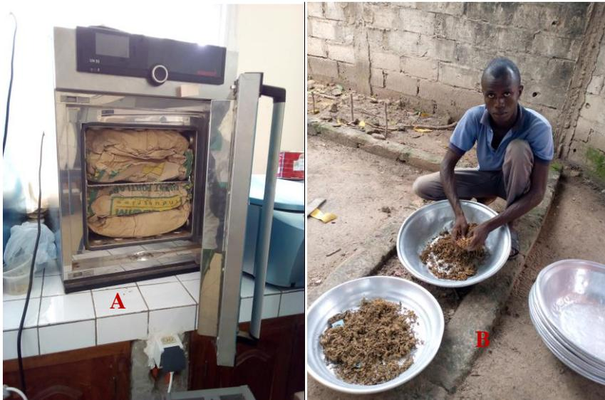
**Figure 10: séchage à l'étuve (A) et à l'air libre (B)**
