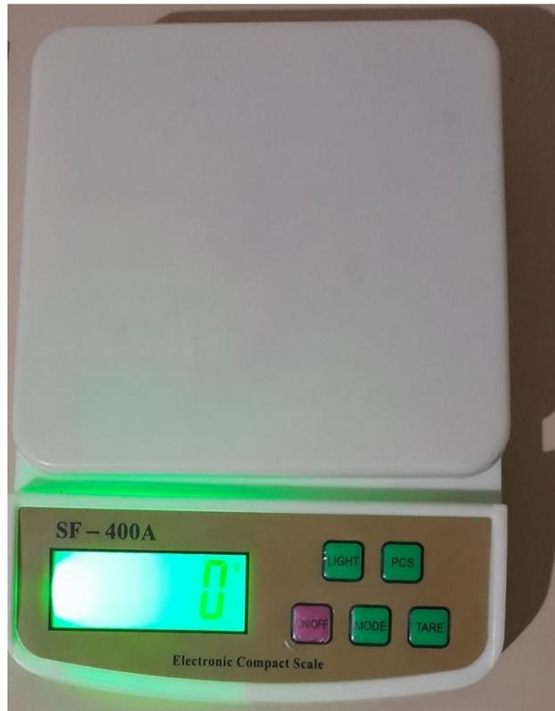
**Figure 14 : Balance électronique précision 1g**
