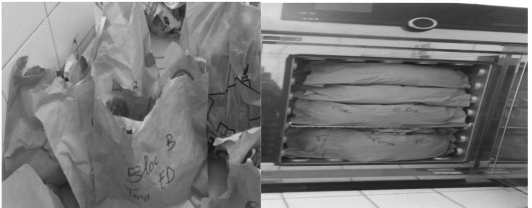
**Figure 5.** Séchage des biomasses à l'étuve.
