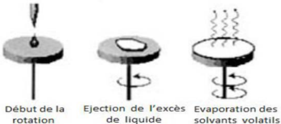
Figure 9: Schéma représentant le principe de préparation d'une couche mince par la méthode de tournette [17].
