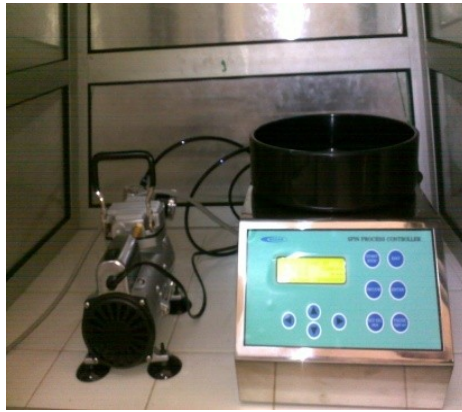
Figure13: Spin-coating MIDAS-1200D installé avec la pompe
