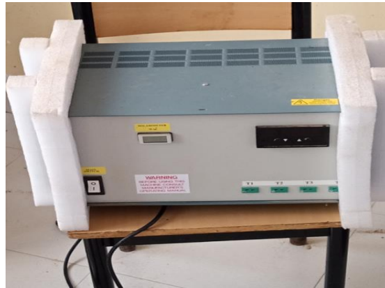
Figure 2.4 : Centrale ou système d'acquisition de données
