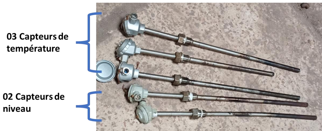
Figure 2.7 : Les différents thermocouples du gazéificateur
