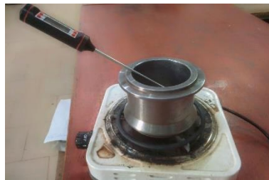
Figure II 3: Testeur de point éclair.
