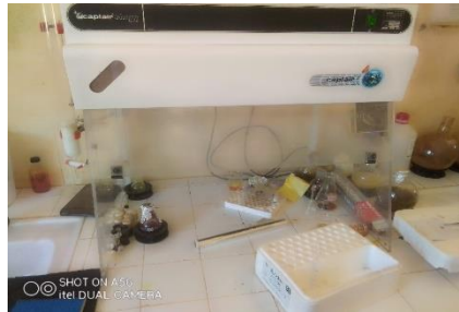
Figure II 8: Hotte à filtration chimique
