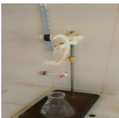
Figure II 6: titrage par rapport à la solution de KOH des huiles oléagineux.
