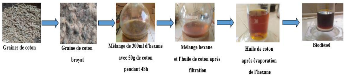
Figure II 11: Les différentes étapes de la transformation du coton en huile
