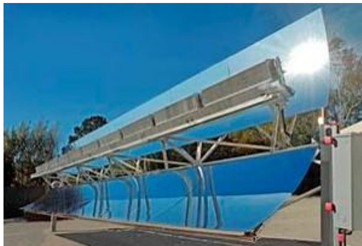
Figure1. 15: Un concentrateur photovoltaïque cylindro-parabolique sur tracker un axe. (Weick 2017)
