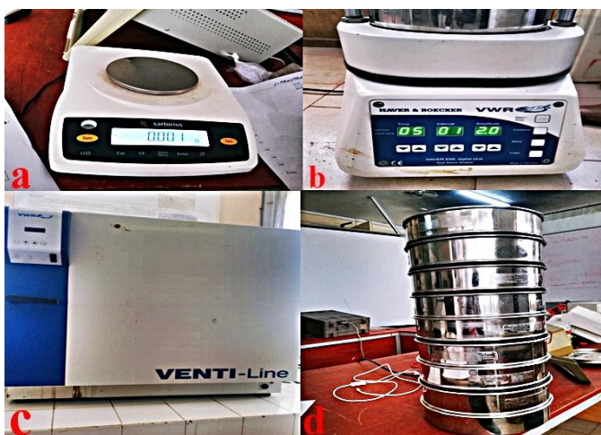
Photo 2 : Appareils utilisés au laboratoire de physique et chimie des matériaux de l'Université Assane SECK de Ziguinchor (a : balance de précision, b : agitateur électrique des tamis c : étuve, d : tamis)
