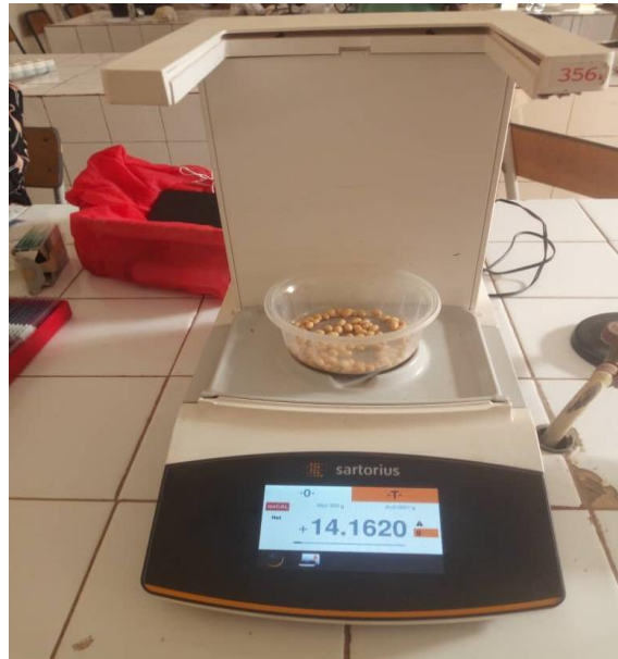
Figure 12: Pesée du poids de 100 graines avec une balance électronique de haute précision
