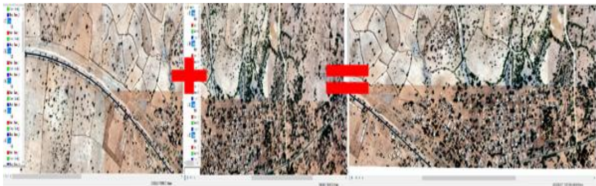
Figure 2: Principe de mosaïquage des images capturées et géoréférencées
