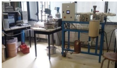
Figure 2- 5 : Photo du système du réacteur à lit fixe (UTC)
