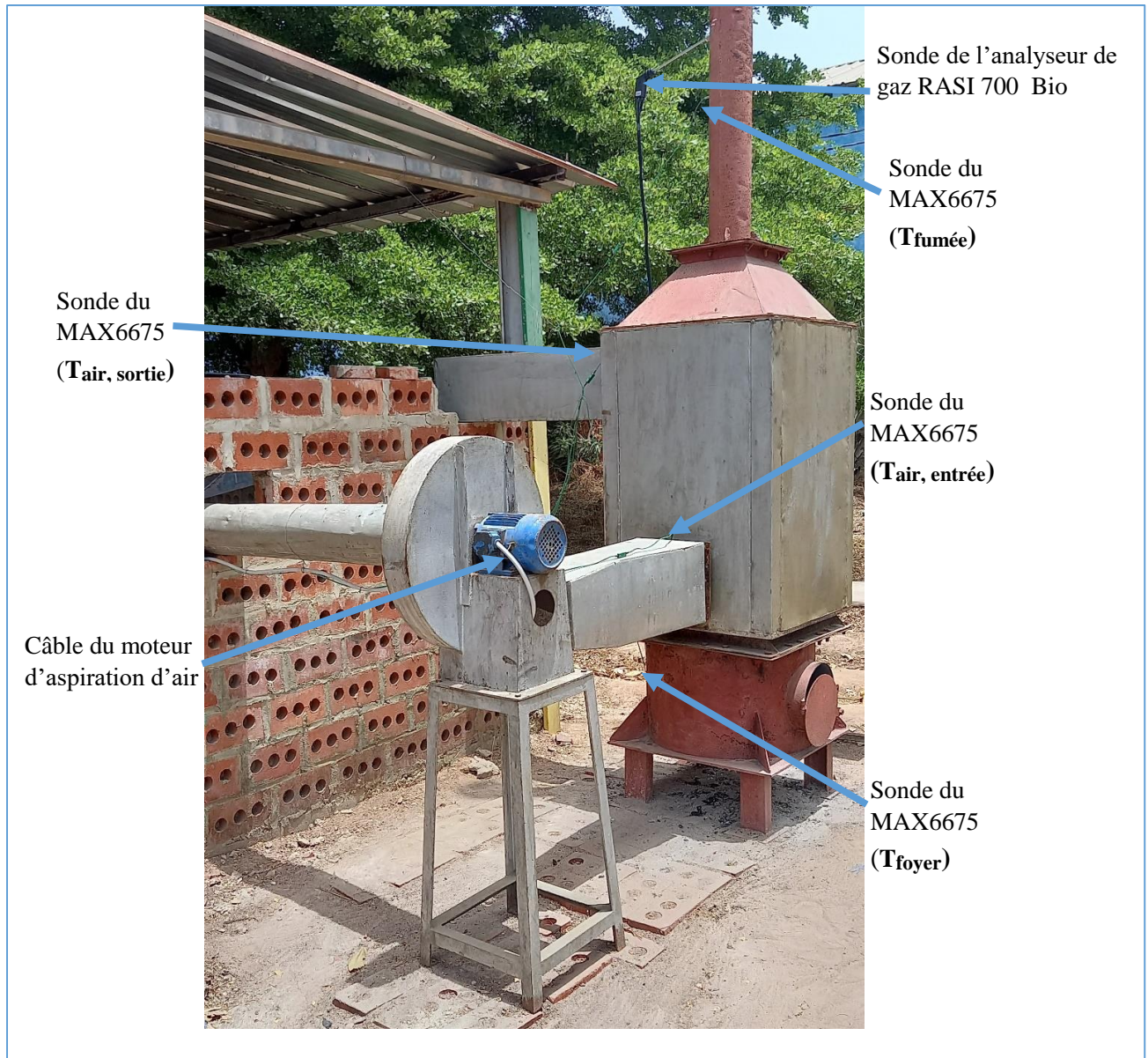
Figure 2.18 : Photo du générateur d'air chaud indirect équipé d'appareils de mesure. L'opération a été contrôlée par deux ordinateurs permettant d'enregistrer et de stocker les données via des logiciels ; MRU4win pour les mesures de gaz par l'analyseur de gaz RASI 700 Bio et PLX-DAQ pour les mesures des températures par les capteurs MAX6675.
