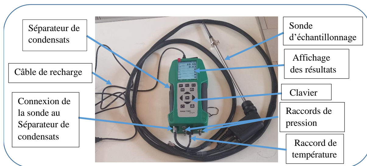
Figure 2.16 : Photo de l'analyseur de gaz RASI 700 Bio et ses composants
