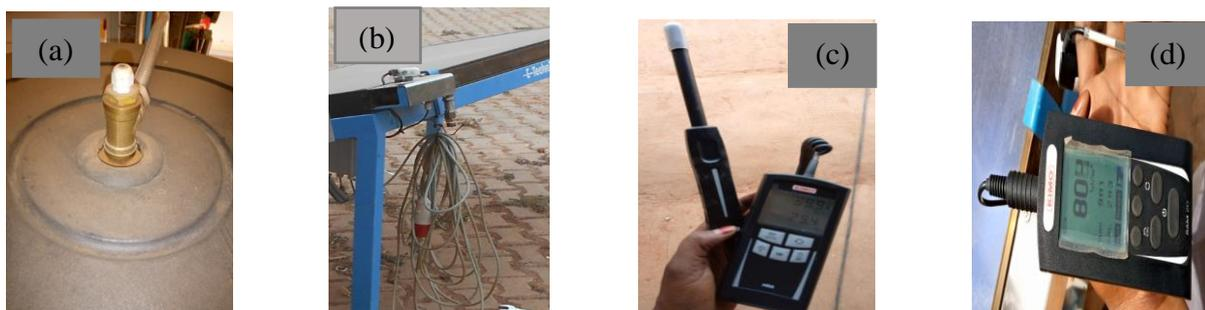
Figure (II.7) : (a) Sonde intégrée au ballon ; (b) Sonde intégrée au capteur ; (c) Thermo-hygromètre HRA ; (d) Solarimètre SAM20
