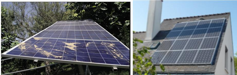
**Figure.III. 1. Module avec ombrage partiel**
