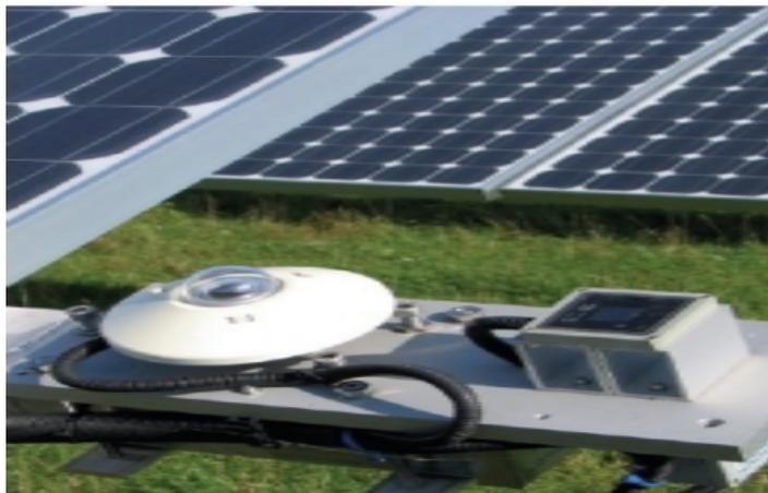
Fig.I. 6. Pyranomètre pour mesurer le rayonnement solaire
