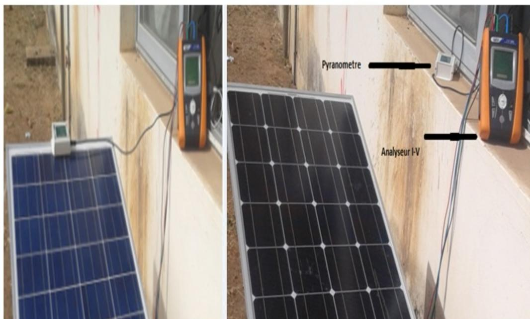
Figure III. 5. Module mono et poly testé à l'aide de l'analyseur I-V
