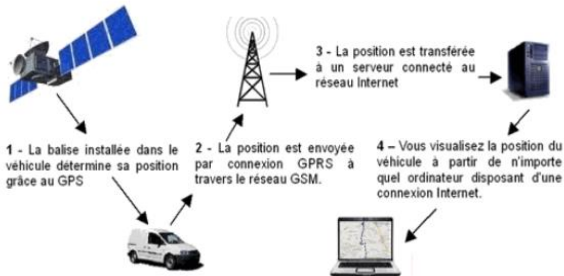
Figure 2 : Principe de la géolocalisation d'un véhicule équipé d'un terminal embarqué
