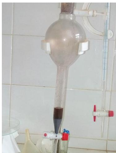
Ampoule à décanté
